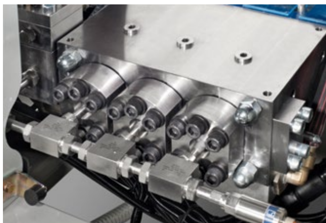
Meer vermogen en veiligheid: hogedrukpomp met hooglichtende veiligheidsklep.
