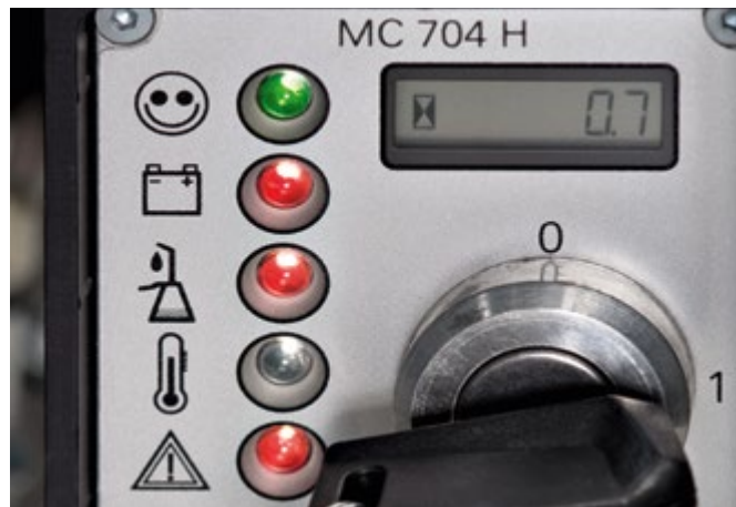
Eenvoudige en veilige bediening: gebruiksvriendelijke besturing, handmatige drukregeling, veiligheidskleppen en noodstopknop.
